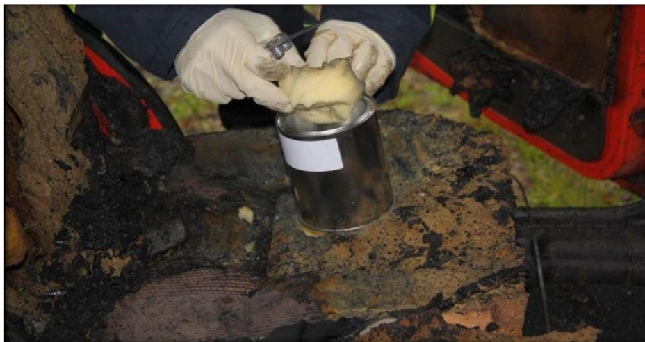
Obr. 3 Odber vzorky do plechovej konzervy
