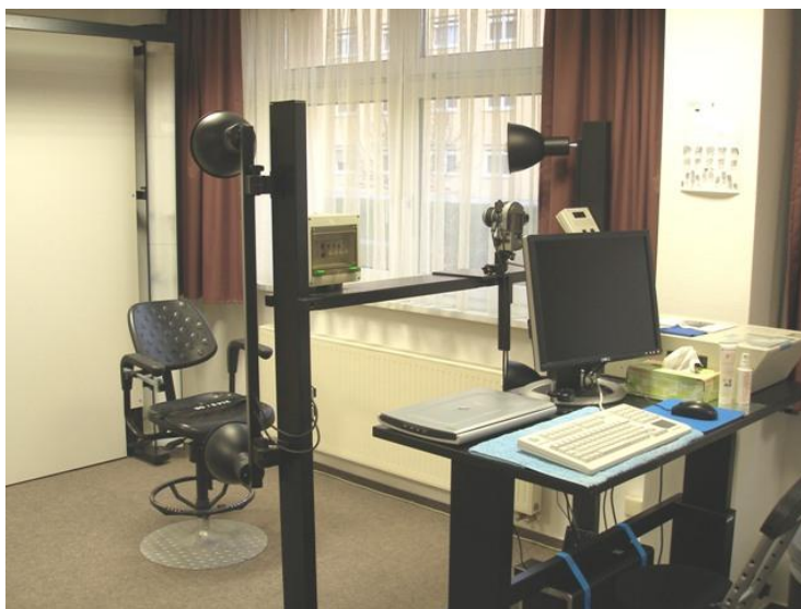
Obr. 1 „Livescan“ – zariadenie v odbornom kabine v odbore kriminalistiky na digitálne snímanie biometrických znakov
