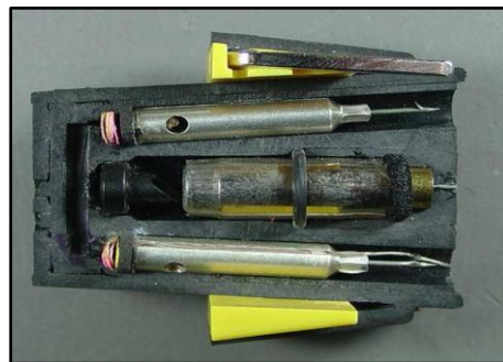
Obrázok 4-12 Náplň so sondami elektrického paralyzátora Taser X26
